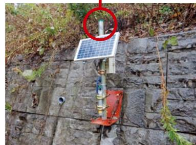
「うちの裏山が見える」状態にしようとしています。固定傾斜計と光デバイスを組み合わせたPOCKET (ポケット) という装置は、普段は定期的に緑のランプが光り、もとの状態から0.1度傾くと、黄色が光る。さら
